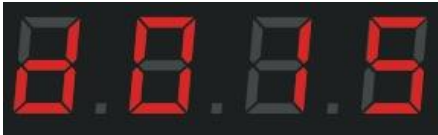
d：SD 卡的程序模式；01：第 1 个程序；5：速度 5
